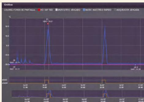
Temperatura, consigna de temperatura y activación del desescarche en la cámara de congelados varios, obtenida del controlador de cámara XR75CX.
