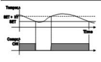
La regulación se realiza de acuerdo a la temperatura medida por la sonda termostática con un diferencial positivo respecto del punto de intervención (set point): si la temperatura aumenta y alcanza el valor del punto de intervención más el diferencial el compresor arranca para detenerse cuando la temperatura alcanza nuevamente del valor correspondiente al punto de intervención.
